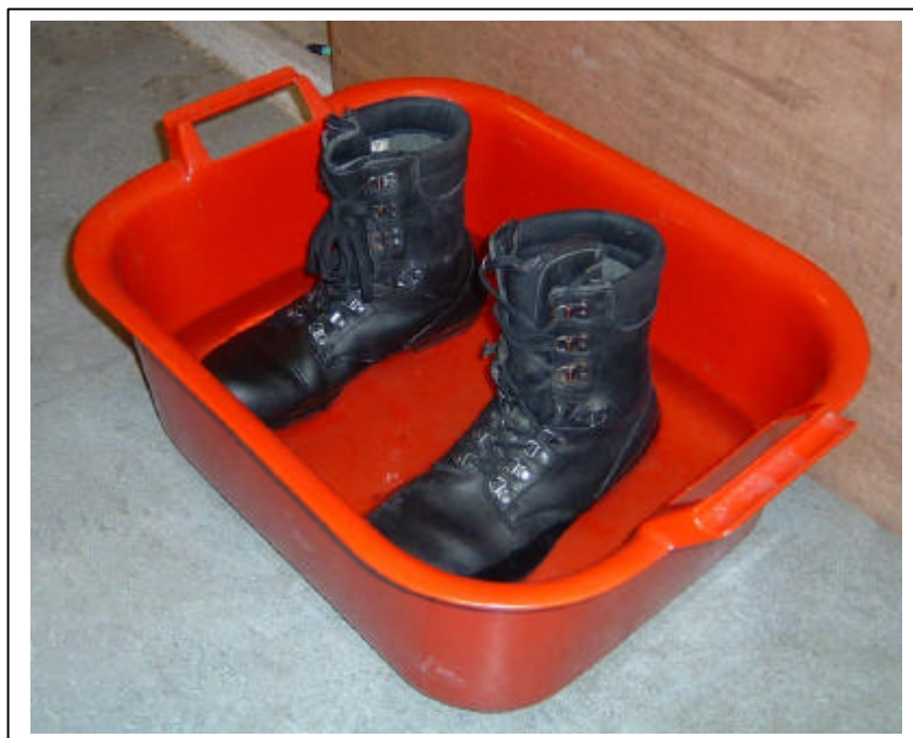
Figur 2 Teststøvler plassert i vannbad for å bestemme vanninntrenging i henholdsvis smurt og usmurt lærstøvel av samme merke og modell
