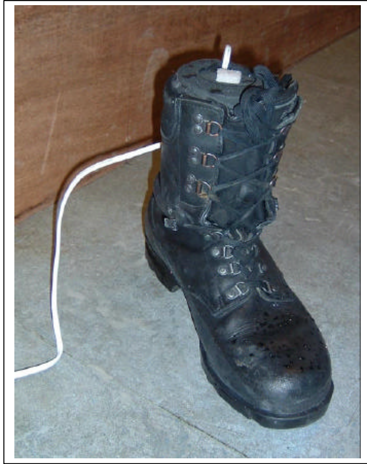
Figur 1 Teststøvel med termofot plassert i støvelen og støvelskaftet avstengt for utlufting av fuktighet inne i støvelen.
